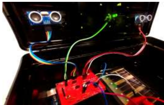
Figura 2.2 Estuche de prácticas basado en tecnología Arduino
