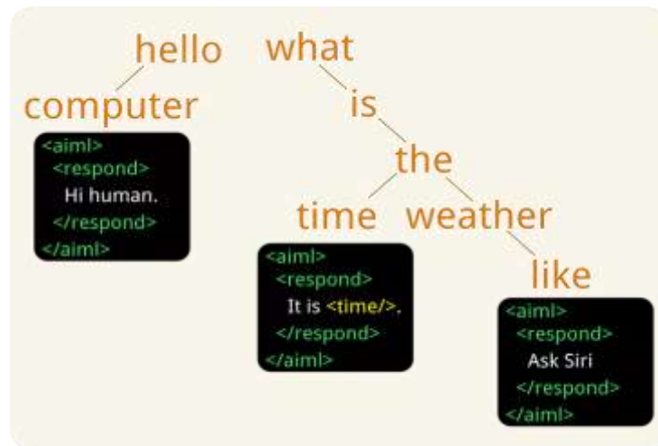
Figura 3.2 Comportamiento de Pandorabots ante la entrada de un usuario
